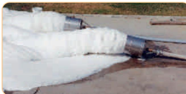
I gruppi mobile a schiuma sono dotati di miscelatore professionale variabile, con possibilità di regolazione da 1% a 6%
